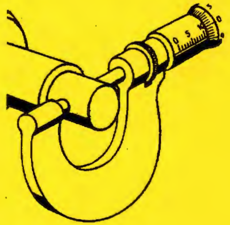
Mesure du \varnothing avec un micromètre.
